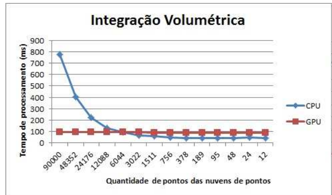
Figura 10 Desempenho do algoritmo de integração volumétrica em CPU e GPU.
