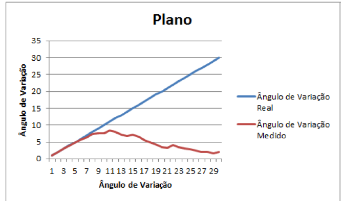
Figura 18 Ângulo de variação medido pelo algoritmo de alinhamento para o modelo plano da Figura 16. O variante do ICP conseguiu estimar o ângulo de variação corretamente até 8 graus de variação.
