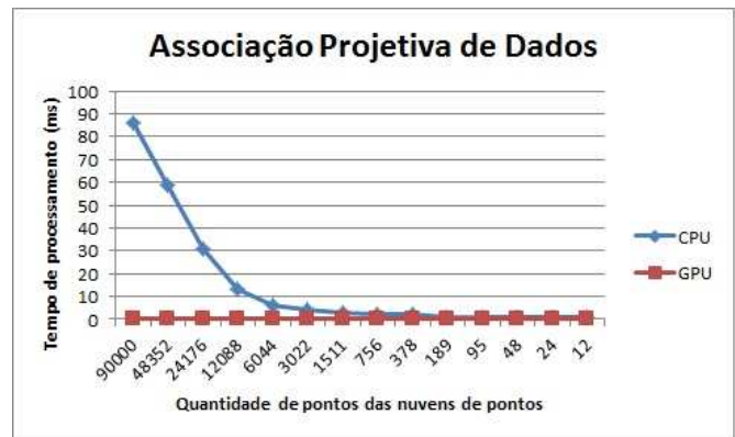
Figura 11 Desempenho do algoritmo de associação projetiva de dados em CPU e GPU.
