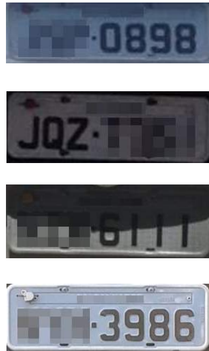
Figura 10: Diferentes condições de iluminação obtidas durante a captura das placas veiculares. Sombras, imagens com tonalidade azulada ou escurecida podem prejudicar o reconhecimento dos caracteres na placa. As placas foram borradas por questões de privacidade.
