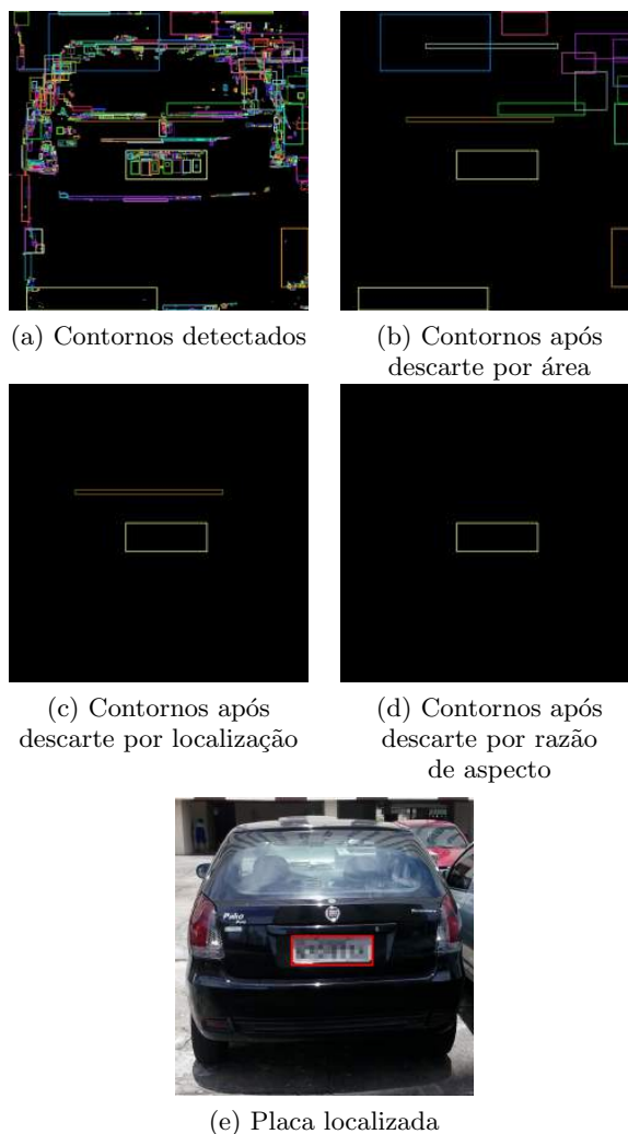
Figura 7: Processo de detecção da placa veicular a partir da remoção dos retângulos que não pertencem a uma placa veicular. Critérios como tamanho (b), localização (c) e razão de aspecto (d) são utilizados para definir qual dos retângulos (a) consiste numa placa veicular (e). As placas foram borradas por questões de privacidade.
